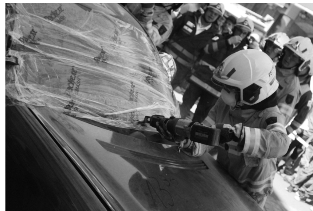
Mit der elektrischen Säbelsäge wird die Windschutzscheibe herausgeschnitten, um den Verletzten aus dem Wrack zu befreien.
